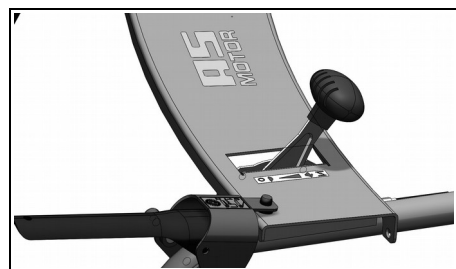
MAX - motorens maks. antall omdreininger
