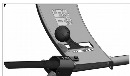
STOP - utkobling av motor
