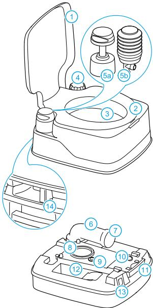
**1 Couvercle** • **2 Lunette** • **3 Cuvette des toilettes** • **4 Bouchon de remplissage d'eau** • **5a Pompe à piston** • **5b Pompe à soufflet** • **6 Bras de vidange** • **7 Bouchon du bras de vidange** • **8 Joint de clapet** • **9 Joint de mise à l'air libre** • **10 Bouton de mise à l'air libre** • **11 Poignée d'ouverture de clapet** • **12 Rangement additifs sanitaires** • **13 Indicateur de niveau de réservoir à matières** (selon le modèle) • **14 Fermoir**
