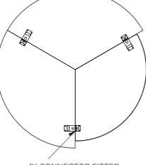
1X CONNECTOR FITTED BETWEEN PIE MODULE
