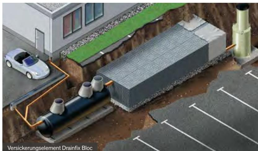
Versickerungselement Drainfix Bloc
