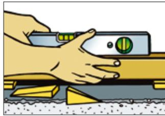
**4** Richten Sie den Elementrahmen durch das Unterlegen von Montageklötzchen (nur unterhalb der senkrechten Rahmenseiten, nicht mittig vom Element) lot- und waagrecht aus. Beachten Sie dabei die Einbauhöhe.
