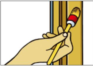
**1** Element auspacken und die Beschaffenheit sowie Ausführung auf Mängel prüfen, gegebenenfalls auch unter der Schutzfolie. Bei Mängeln darf das Element nicht eingebaut werden! Unbehandelte Holz-Elemente vor dem Einbau mit geeignetem Oberflächenanstrich endbehandeln (Rahmen und Flügel rundherum auf allen Seiten, Beschläge und Dichtungen nicht überstreichen).
