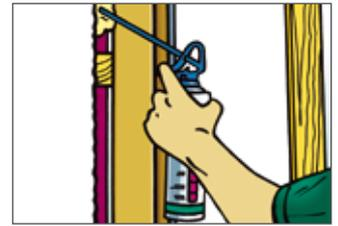
**11** Die Fuge zwischen Elementrahmen und Bauwerk entsprechend den Anforderungen des Bauvorhabens ausfüllen/abdichten. Bei einer Funktionsstörung das Element nicht einschäumen oder einputzen! **ACHTUNG:** Bei der Verwendung von Montageschaum muss der Rahmen ausgespreizt werden.
