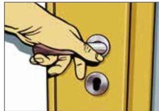
**9** Flügel einhängen und den Elementrahmen auf der Verriegelungsseite (Griffseite) zum Flügel hin ausrichten (Flügel muss komplett am Rahmen anliegen). Rahmen mit Keilen fixieren. Funktionsprüfung durchführen (schließt und öffnet das Element richtig?), gegebenenfalls Korrekturen durch Nachsetzen der Keile vornehmen. Die casafino Bauelemente sind werkseitig voreingestellt und vorgeklotzt, die Endeinstellung und Endverklotzung muss bauseitig bei der Montage erfolgen.
