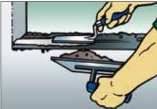
**2** Elementflügel aushängen. Unebenheiten in der Laibung sowie Schäden oder Rückstände durch den Ausbau alter Elemente ausbessern. Bei Türen darf die Bodenschiene nicht hohl liegen, sie muss mit Mörtel unterfüllt sein.
