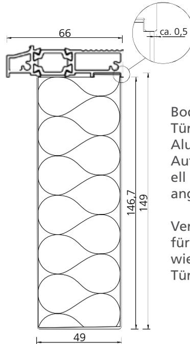
Bodeneinstandsprofile für Türen aus Kunststoff und Aluminium werden ohne Aufpreis werkseitig individuell nach Vorgabe der Höhe angepasst.
