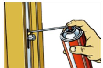
**12** Beschlag und Profilzylinder montieren. Vergewissern Sie sich, dass beim Bohren für die Befestigung des Beschlages das Schloss oder andere bewegte Teile nicht beschädigt werden können. Die beweglichen Teile dann reinigen und mit einem geeignetem Öl/Fett (säurefrei) behandeln. Das Fetten/Ölen mindestens einmal pro Jahr wiederholen.
