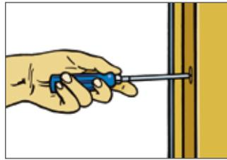
**8** Den Elementrahmen zuerst an der Bandseite mit Rahmendübeln/Montageschraubefestigen.
