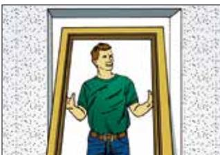
**3** Stellen Sie den Elementrahmen (Öffnungsrichtung beachten, Bandseite ist die Innenseite, sofern nicht anders bestellt) in die Maueröffnung. Der Abstand des Rahmens zum Mauerwerk sollte auf beiden Seiten etwa gleich groß sein.
