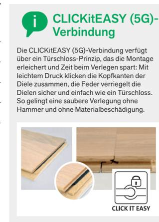
Die CLICKitEASY (5G)-Verbindung verfügt über ein Türschloss-Prinzip, das die Montage erleichtert und Zeit beim Verlegen spart: Mit leichtem Druck klicken die Kopfkanten der Diele zusammen, die Feder verriegelt die Dielen sicher und einfach wie ein Türschloss. So gelingt eine saubere Verlegung ohne Hammer und ohne Materialbeschädigung.
