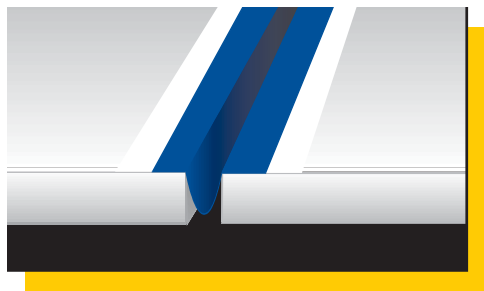
Schlaufenförmige Ausbildung von Mapeband im Dehnfugenbereich
