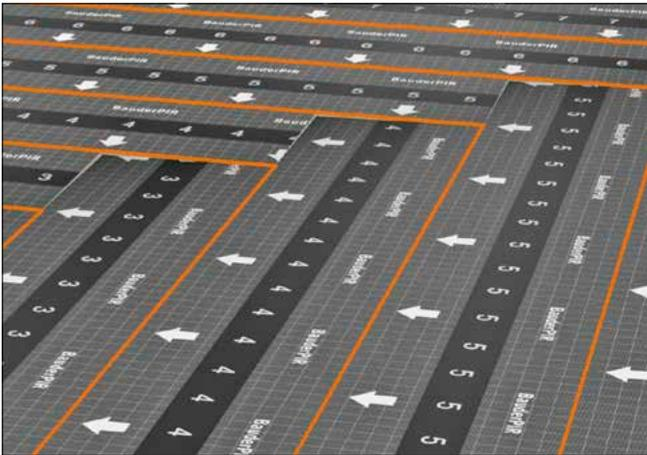
Auch im Gratbereich werden die Gefälledämmplatten verlegt. Hier findet jedoch eine Dickenabstufung um eine Stufe statt. Das bedeutet z.B. in Plattenreihe 3 wird im Grat eine Gefälledämmplatte der Stufe 2 eingelegt. Diese kann sich wieder nach der linken oder der rechten Gratseite ausrichten, beides ist möglich.
