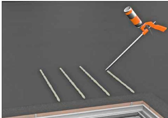
Die BauderPIR FA Gefälle Dämmplatten sind auf die Kleberrauten aufzulegen und leicht anzupressen. Die Platten dürfen vor Aushärtung des Bauder Schaumklebers nicht begangen werden.
