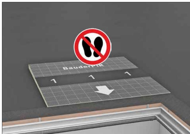
Die komplette Dachfläche mit BauderPIR FA Gefälle verschnittoptimiert belegen, d.h. Abschnitte bzw. Reststücke an geeigneter Stelle weiter verwenden.
