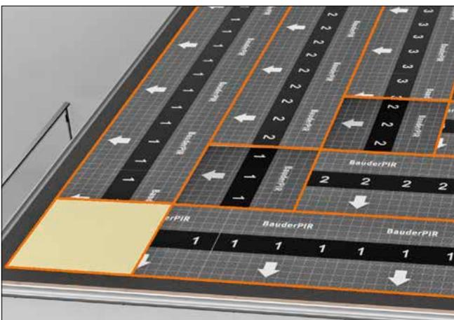
Wichtig im Gratbereich ist, dass durch die Dickenabstufung immer eine ganze Gefälleplatte verlegt werden muss. Dies bedeutet, dass der Grat entsprechend einzumessen ist.
