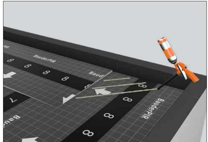
Bauder Schaumkleber wird aufgebracht (3-4 Streifen parallel zur langen Seite), mit Sprühnebel befeuchtet und das Füllstück eingelegt:
