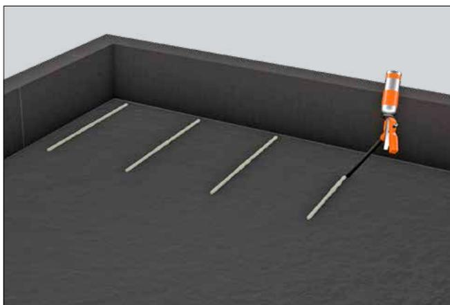
Bei objektspezifischen Besonderheiten kann sich die notwendige Klebermenge erhöhen. Zur Verklebung darf ausschließlich der Bauder Schaumkleber verwendet werden. Bei geplanter Verwendung von anderen Klebern und bei objektspezifischen Besonderheiten informieren Sie sich bitte bei der Bauder Anwendungstechnik.
