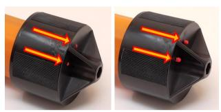
1.7 Bei korrekter Montage sind nun die Kontrollstifte sichtbar. Bei der Montage kann die Dichtungsmasse am Randbereich austreten. Dies ist so vorgesehen und stellt keinen Mangel dar.
