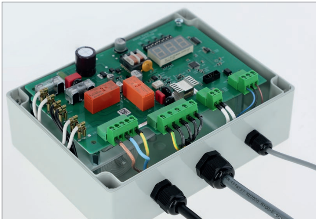
Illustration 9: Printkortet i styringshuset (kondensator bag printkortet)
