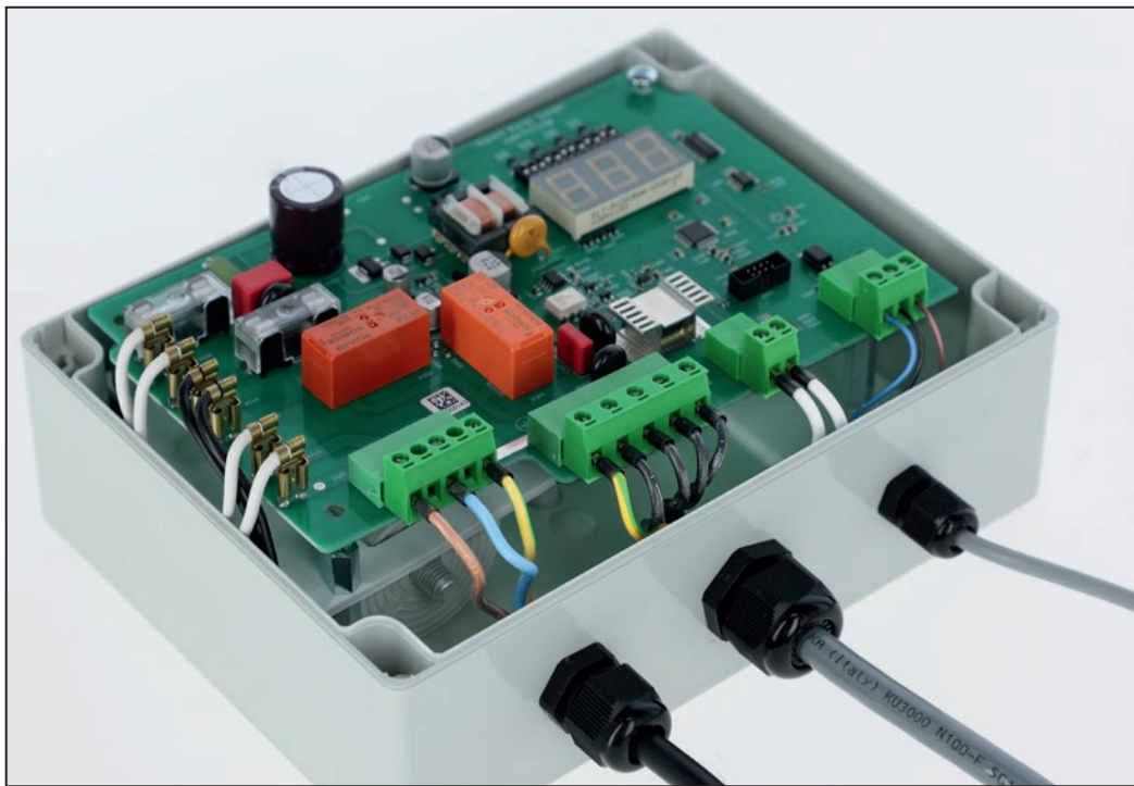
Kuva 9: Piirilevy ohjausyksikön kotelossa (kondensaattori piirilevyn takana)
