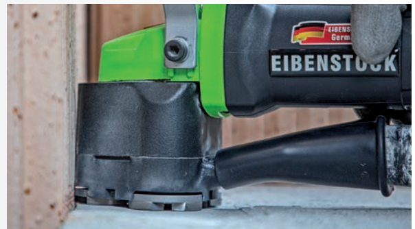
Schleifen bis direkt an die Kante*
