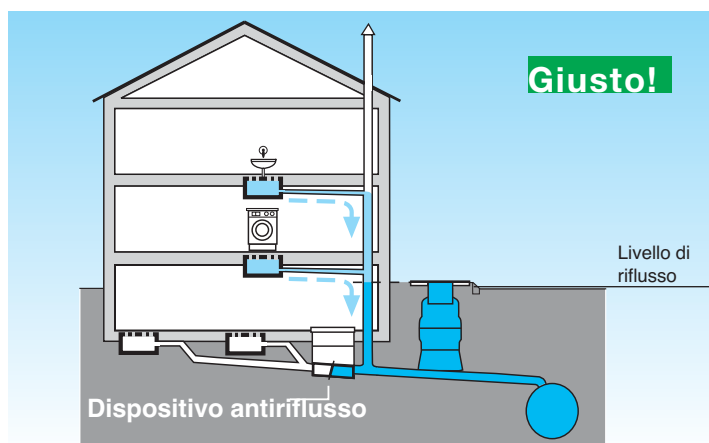
Installazione di un dispositivo antiriflusso sul punto giusto
