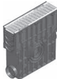
Einlaufkasten mit Kunststoff-Eimer, mit Klemm-Maschenrost 30/10, Pkw-befahrbar, arretiert
