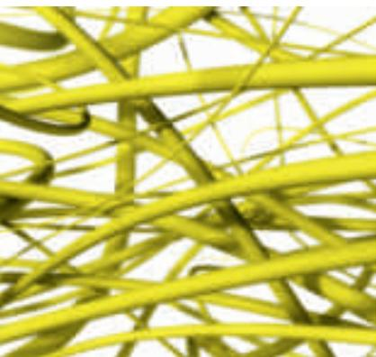
Mineralwolle hat eine offene Faserstruktur und ist nicht kapillar aktiv. So kann auftretende Feuchte durch Mineralwolle ungehindert entweichen. Bauschäden werden vermieden!
