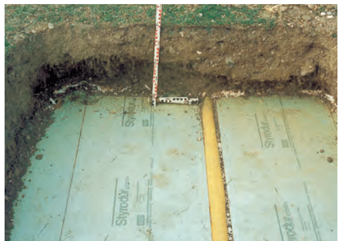
Abb. 36: Probeentnahme bei einem zehn Jahre alten, begrünten Umkehdach.
