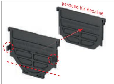
5. Für einen optimalen Sitz, die Stirnwand gemäß Beschriftung zuschneiden. Der mit einem «Y» gekennzeichnete Bereich sowie die zwei Clips «A» sind zu entfernen.
