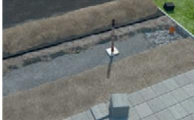
2. Den erdfeuchten Magerbeton (C 15/ B 15) in den Graben füllen und verdichten.
