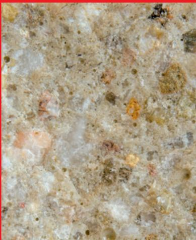
Polymerbeton im Werkstoffsschnitt
