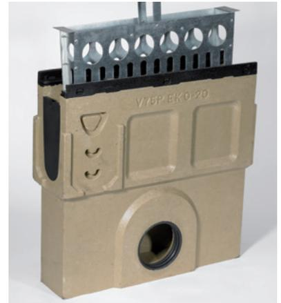
ACO DRAIN® PowerDrain Einlaufkasten V 75/100 P mit Schlammeimer stahlverzinkt, mit ausschneidbarer Anschlusschablone, mit integrierter Lippenlabyrinthdichtung (wahlweise mit DN/OD 110 oder 160)
