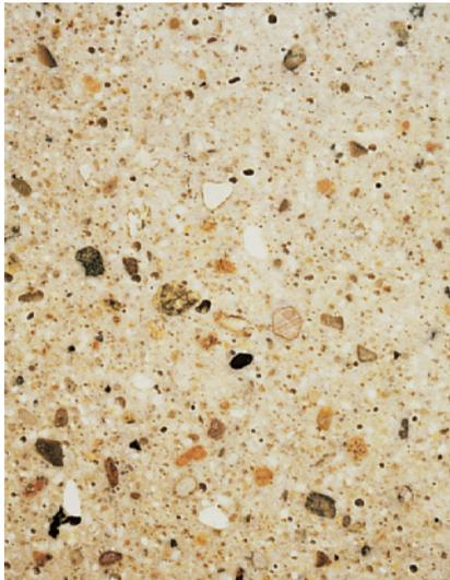
Die besondere Materialzusammensetzung und modernste Fertigungstechnologien verleihen dem ACO Polymerbeton sein herausragendes Eigenschaftsprofil. ACO Polymerbetonprodukte verfügen z. B. bei vergleichbarer Dichte über wesentlich höhere Festigkeitswerte und ein geringeres Gewicht als vergleichbare Betonprodukte.
