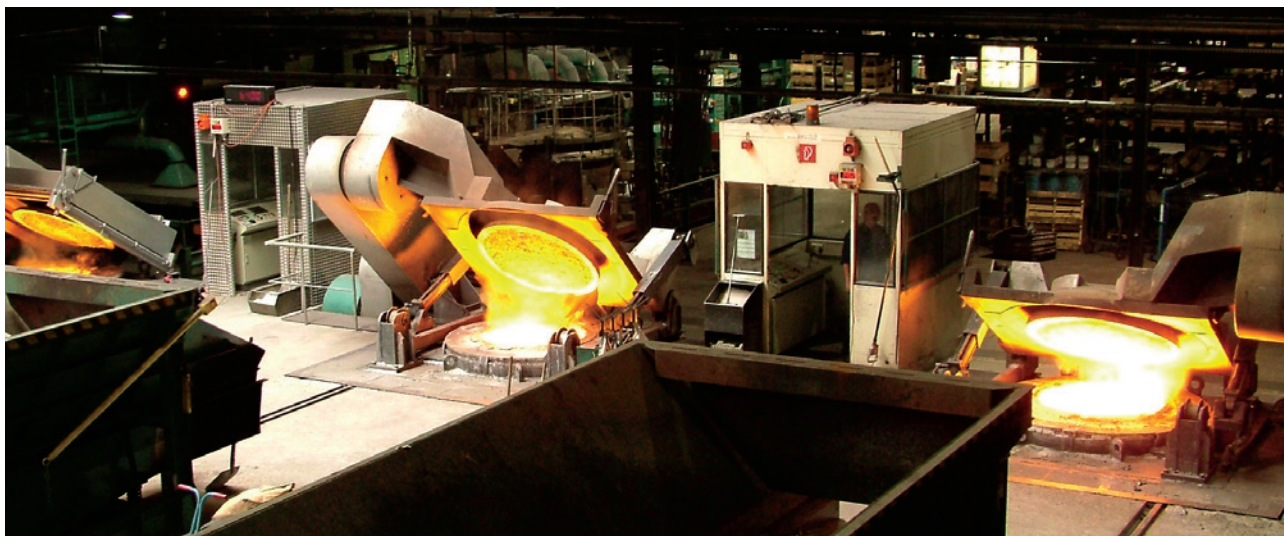
Moderne Mittelfrequenz-Induktions-Schmelzöfen, ACO Kaiserslautern
