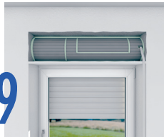
Tipp: Zur nachträglichen Revision Dämmung einschneiden und aufklappen.
