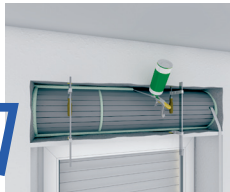
7 Dämmplatten mit Montageschaum am Anschlag und in den Stoßbereichen verkleben und abdichten.
