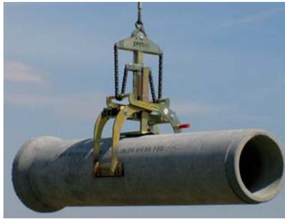
... beim Verlegen von Rohren – sicher, schnell und effektiv mit dem kraftvollen Rohrgreifer RG.
