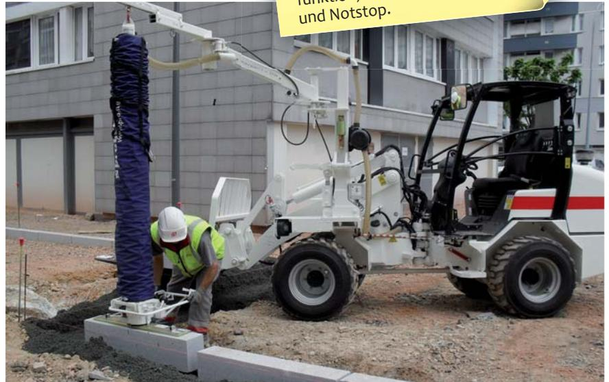
Motorisierung: Kubota · 4 Zylinder · 60 PS · Geschwindigkeit: max. 25 km/h · Max. Hubhöhe der Palettengabel 2.670 mm · Tragfähigkeit der Palettengabel: max. 2.000 kg · Gesamtgewicht: ca. 4.100 kg
