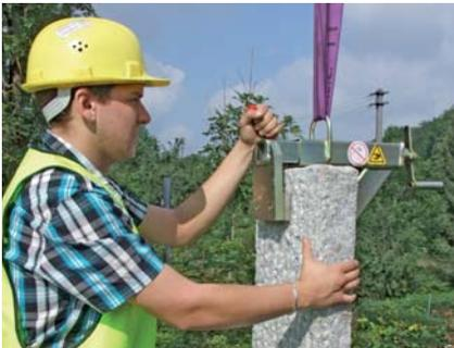
... für schnelles, sicheres und effektives Handling von Granitstelen – Stelensetzer SLS-8/20-G.
