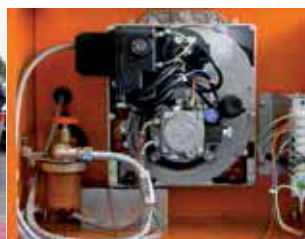
ISK®-Brenner mit original HEYLO-Ölvorwärmung
