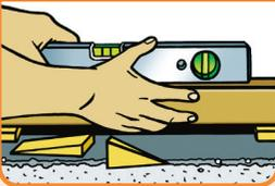
**4** Den Elementrahmen zuerst an der Bandseite mit Rahmendübeln / Montageschaum befestigen.
