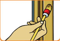
**1** Element auspacken und die Beschaffenheit sowie Ausführung auf Mängel prüfen, gegebenenfalls auch unter der Schutzfolie. Bei Mängeln darf das Element **nicht** eingebaut werden! Unbehandelte Holz-Elemente vor dem Einbau mit geeignetem Oberflächenanstrich endbehandeln (Rahmen und Flügel rundherum auf allen Seiten, Beschläge und Dichtungen nicht überstreichen).
