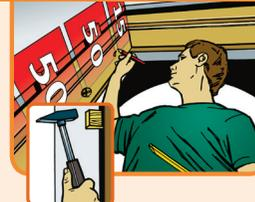
**6** Markieren Sie die Punkte für Dübelbohrungen im Mindestabstand von 15 cm aus der Ecke heraus und maximal 50 cm zwischen den einzelnen Bohrungen.
