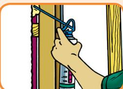
**11** Die Fuge zwischen Elementrahmen und Bauwerk entsprechend den Anforderungen des Bauvorhabens ausfüllen / abdichten. Bei einer Funktionsstörung das Element **nicht** einschäumen oder einputzen! **ACHTUNG:** Bei der Verwendung von Montageschaum muss der Rahmen ausgespreizt werden.
