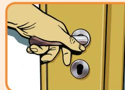
**9** Flügel einhängen und den Elementrahmen auf der Verriegelungsseite (Griffseite) zum Flügel hin ausrichten (Flügel muss komplett am Rahmen anliegen). Rahmen mit Keilen fixieren. Funktionsprüfung durchführen (schließt und öffnet das Element richtig?), gegebenenfalls Korrekturen durch Nachsetzen der Keile vornehmen. Casafino Bauelemente sind werkseitig voreingestellt und vorgeklotzt, die EndEinstellung und Endverklotzung muss bauseitig bei der Montage erfolgen.
