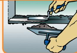
**2** Elementflügel aushängen. Unebenheiten in der Laibung sowie Schäden oder Rückstände durch den Ausbau alter Elemente ausbessern. Bei Türen darf die Bodenschiene nicht hohl liegen, sie muss mit Mörtel unterfüttert sein.
