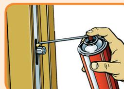
**12** Beschlag und Profilzylinder montieren. Vergewissern Sie sich, dass beim Bohren für die Befestigung des Beschlages das Schloss oder andere bewegte Teile nicht beschädigt werden können. Die beweglichen Teile dann reinigen und mit einem geeignetem Öl / Fett (säurefrei) behandeln. Das Fetten / Ölen mindestens einmal pro Jahr wiederholen.
