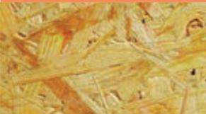
Derartige Untergründe sind keine geeigneten Putzträger. Bevor sie mit einem Putzträger, z. B. *Knauf Renovierboard* oder *Knauf Ausbauplatte GKB 9,5 mm*, versehen werden können, werden sie fest verschraubt und in Nut und Feder verleimt. Darüber
