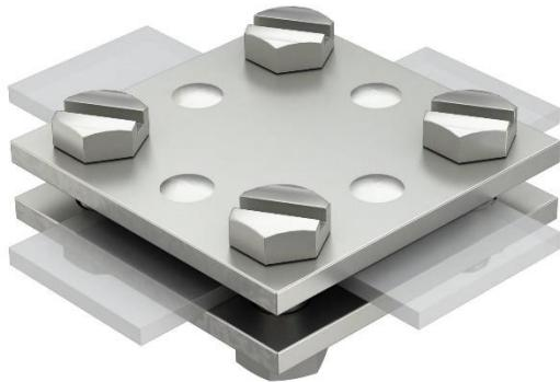
**Art. Nr.:** 5314574**geprüft:** DIN EN 62561-1 (VDE 0185-561-1)**Typ:** KVG 33 V4A**Bezeichnung:** Kreuzverbinder fl/fl**Material:** Edelstahl**Güte Platte:** V4A**Abmessung/Platte:** 60mm x 60mm x 3mm**Schrauben/Muttern:** 4 x Sechskantschrauben M8 x 25mm
