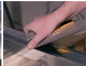
Abb. 6: Gleichmäßig auf dem Profil aufkleben
