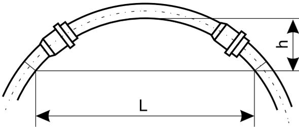
(Rohre > DN 200 lassen sich auf Grund der höheren Eigensteifigkeit kaum noch biegen)
