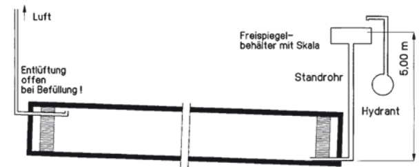
Bild 10 Prüfung auf Wasserdichtheit
