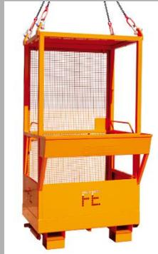
Arbeitsbühne für höchstens zwei Personen und Werkzeug. Nutzlast 250 kg, Breite 1140 mm, Länge 1200 mm; geeignet für Gabelstapler und Kranbetrieb, serienmäßig mit praktischer Werkzeugablage, vier Kranösen (ohne Kette), und seitlicher Tür zum Einstieg.
