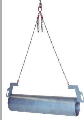
Röhrenhaken aus einer verwindungssteifen Stahlkonstruktion zum Auf- und Abladen von horizontal liegenden Rohren. Die Röhrenhaken hängen an einem zweisträngigen, verkürzbaren Kettengehänge und erlauben den Transport von maximal 4,0 m langen Rohren.
