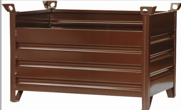
Aus profilierten Eckpfosten, mit 2 mm starken rippenverstärkten Trapezblechboden und rippenverstärkten Seitenwänden, mit angepressten Stapeltaschen und Kranösen. Deckel möglich.
