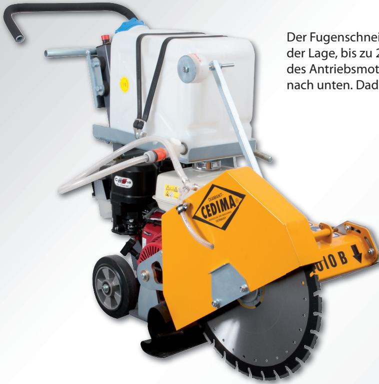
Der Fugenschneider CF-1010 B ist trotz geringer Abmessungen in der Lage, bis zu 200 mm tief zu schneiden. Die extrem tiefe Einbaulage des Antriebsmotors verlagert den Schwerpunkt der Maschine stark nach unten. Dadurch wird eine besonders hohe Kippsicherheit erreicht.
