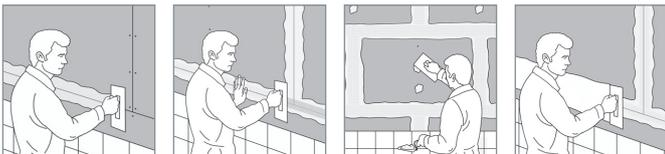
Für die vollflächige Verspachtelung AQUAPANEL® Q4 Finish mit einem ca. 20 cm breiten Glätter gleichmäßig auftragen (Schichtstärke mind. 1 mm). Dabei unebene Stellen in den Fugen füllen und die Oberflächenstruktur glätten (ggf. nach dem Trocknen schleifen). Anschließend eine weitere Schicht AQUAPANEL® Q4 Finish auftragen (Schichtstärke ca. 0,5 mm) und nach dem Trocknen mit Schleifpapier (Körnung 120 oder feiner) nachbearbeiten.
