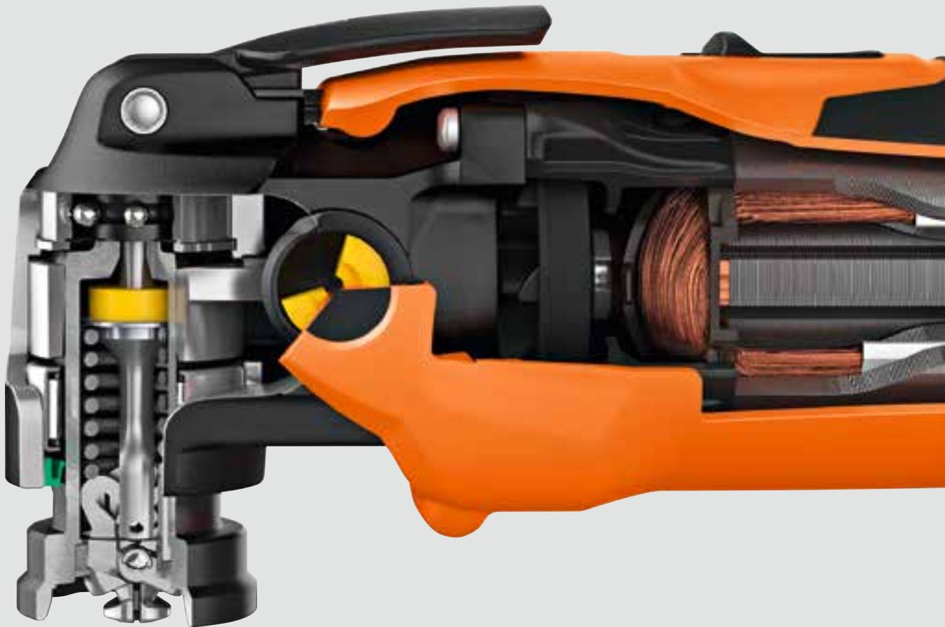
Das Anti-Vibrationssystem der FEIN Oszillierer verringert durch die Entkopplung von Gehäuse und Motor einerseits Vibrationen und Laufgeräusche, was das Arbeiten deutlich komfortabler macht.
