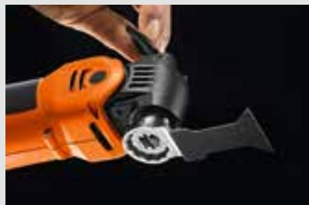
Zum Lösen den Spannhebel öffnen ...
