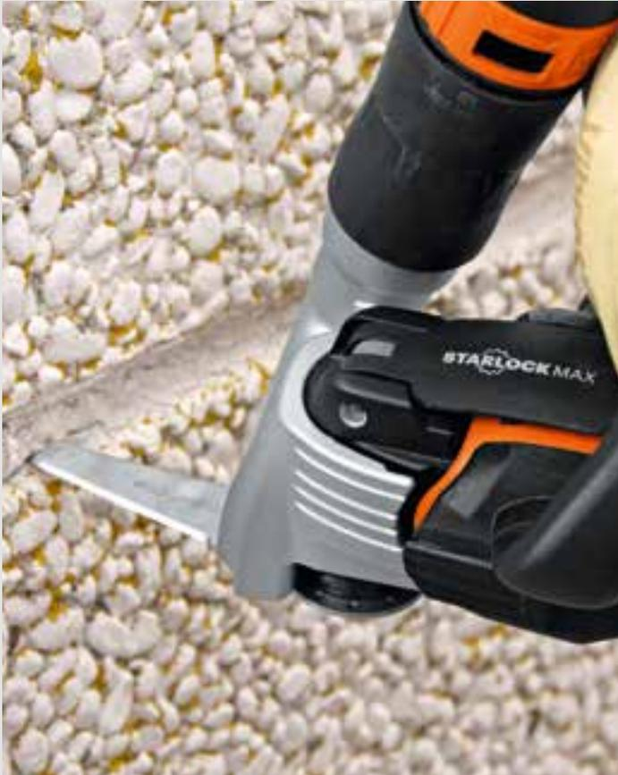
Bei gefährlichen Fugenmaterialien (z. B. PCB) kommt die Staubabsaugung zum Einsatz.
