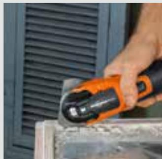
Durch Oszillationsbewegung keine Glasbruchgefahr.
