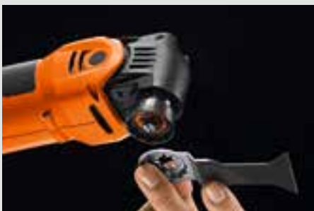
Einfach Zubehör in der Starlock-Aufnahme positionieren und einklicken.
