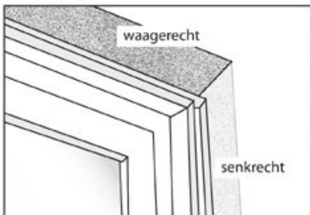
Eventuell überstehenden Montageschaum bündig zum Blendrahmen entfernen. Schutzfolie des Schaumklebebandes an einem Ende der Anputzleiste ein Stück ablösen und Anputzleiste mit der Klebefläche des Schaumklebebandes am oberen Ende des Blendrahmens fixieren. Schutzfolie schrittweise nach unten abziehen und die Anputzleiste nach und nach an den Blendrahmen mit dem Montageroller andrücken. Bei WDV-Systemen auf eine ausreichende Blendrahmenüberdeckung gem. DIN 4108 Beiblatt 2 achten.
