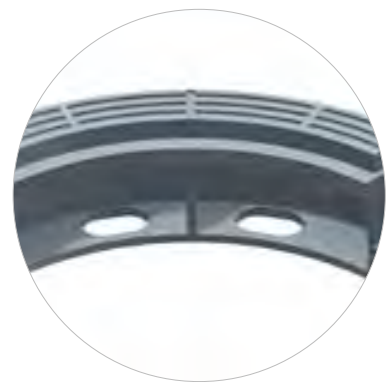
Feste Verankerung zwischen Schachtabdeckung und Schachtbauwerk durch Mörteltaschen im Rahmen
