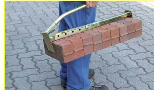
Zuverlässig zupackendes Werkzeug für den manuellen Transport von Klinkersteinen und dergl. von der Palette zum Verarbeitungsort
