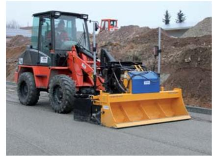
... planieren mit dem Radlader? Kein Problem! Einfach LEVELKING LK montieren und los geht's.
