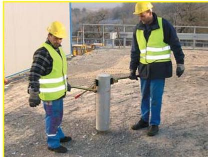
Optimal zum Tragen und Dicht an Dicht Versetzen von Beton- und Holzpalisaden.
