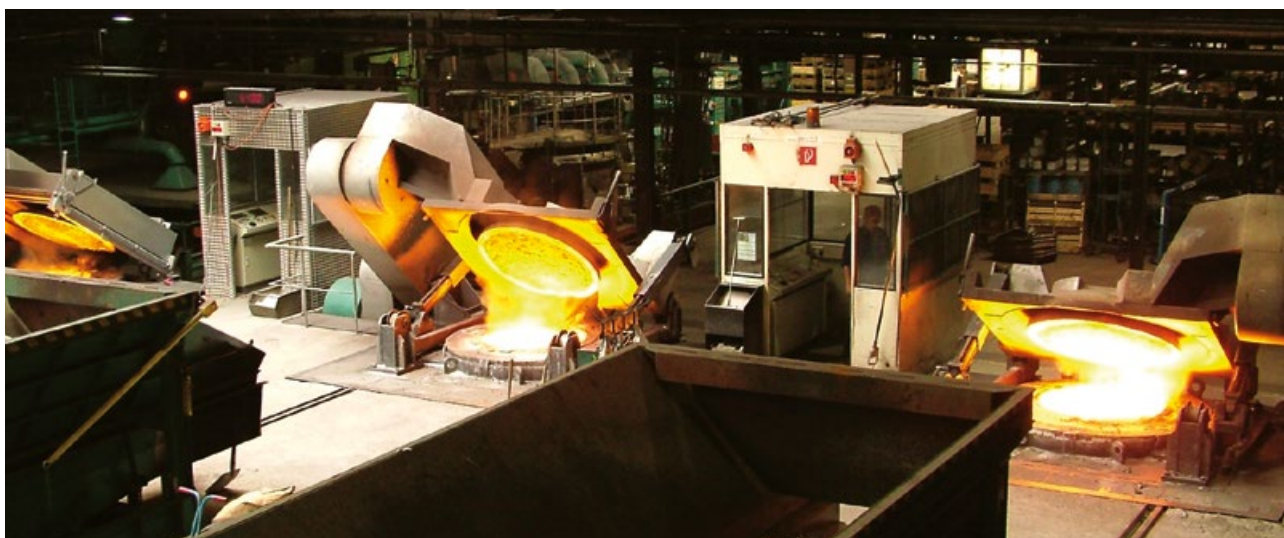
Moderne Mittelfrequenz-Induktions-Schmelzöfen, ACO Kaiserslautern
