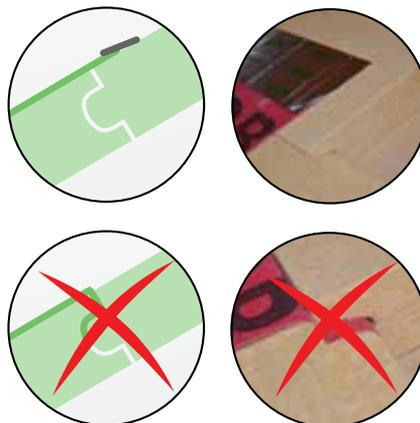
Der Anschluss der PAVATEX Abdeckbahn ADB erfolgt flächig auf die Unterdeckplatte ISOLAIR/ISOROOF/PAVATHERM-PLUS mit den dazugehörigen Klebkomponenten aus dem PAVATEX Dichtsystem.
