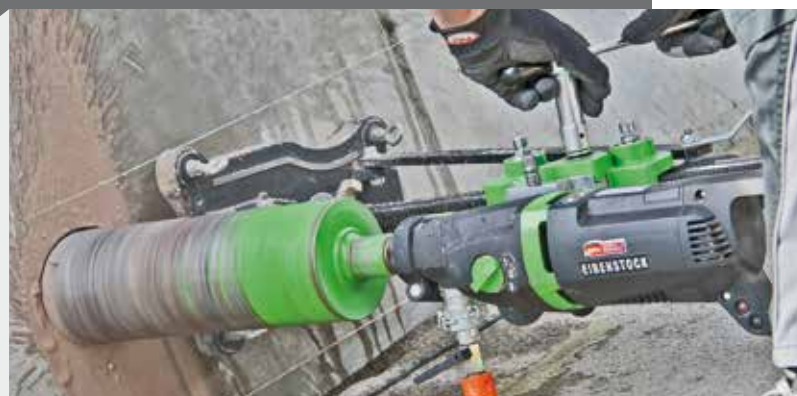
BST 182 V/S: auf vier Spezialkugeln gelagerter Schlitten
