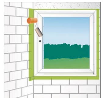
Bild 8: Folie mit Andruckroller anrollen
