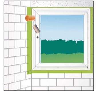
Bild 10: Folie mit Andruckroller anrollen
