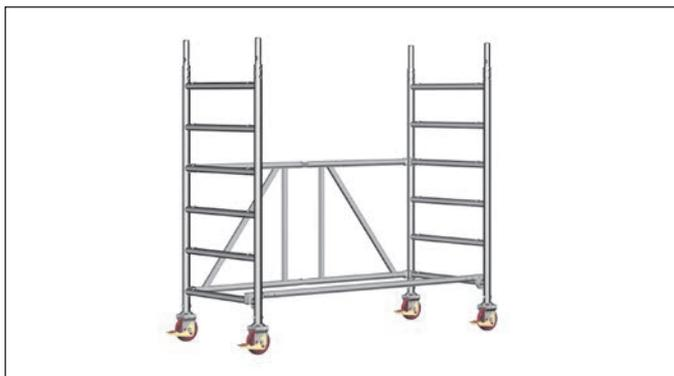
1. Das Grundgerüst 9 auseinanderziehen, Gelenke im Faltelement fest einrasten und mit einer Rückenlehne 16 an der untersten Quersprosse aussteifen.
