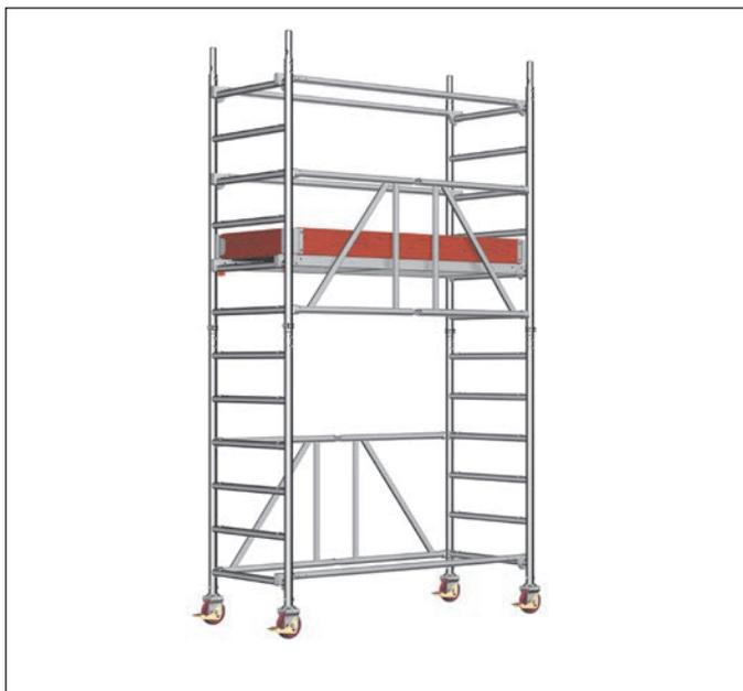
3. Zweites Grundgerüst 9 öffnen und Gelenk im Faltelement fest einrasten. Um 180° zum ersten Grundgerüst gedreht aufstecken. Die Stöße sind mit Federsteckern 15 zu sichern.
