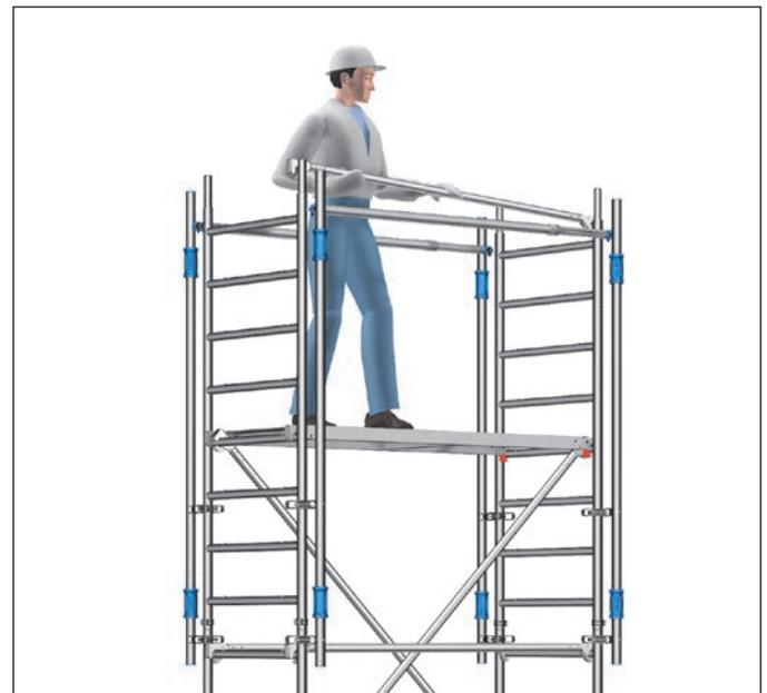
Bild 6: Sichere Montage der Rückenlehnen mit MSG
