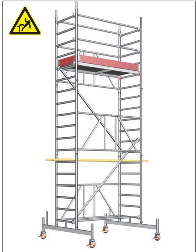
1. Zweites Grundgerüst 9 öffnen und Gelenk im Faltelement fest einrasten. Um 180° zum ersten Grundgerüst gedreht aufstecken. Die Stöße sind mit Federsteckern 15 zu sichern.
