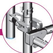
Um ein unbeabsichtigtes Abgleiten des Montagepfostens zu vermeiden, muss auf Höhe einer Einrastklaue eine Rückenlehne montiert sein.
