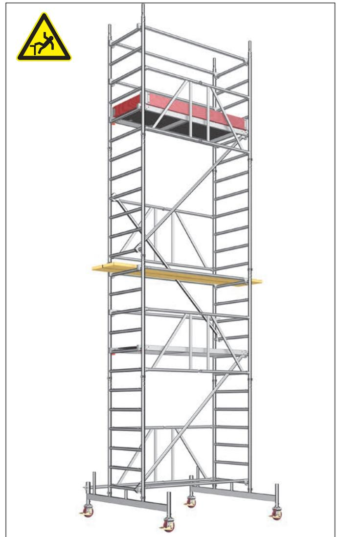
1. Zweites Grundgerüst 9 öffnen und Gelenk im Falteile fest einrasten. Um 180° zum ersten Grundgerüst gedreht aufstecken. Die Stöße sind mit Federsteckern 15 zu sichern.
