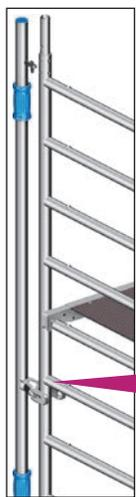
Der Montagepfosten des MSG kann von einem Monteur aus zwei Positionen montiert und demontiert werden:
