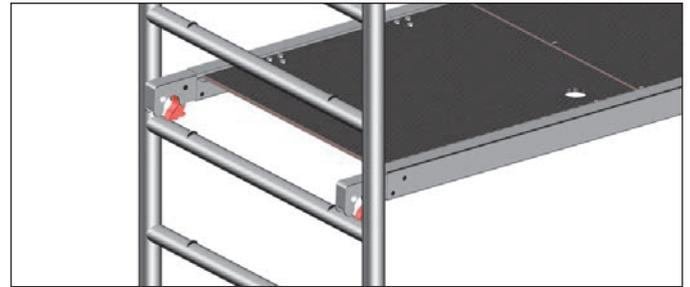
Die roten Schließbügel der Böden ermöglichen den mühelosen Ein- und Ausbau durch eine Person; sie sind zuerst zu lösen und der Belag mit den geöffneten Bügeln auf die Sprosse aufzulegen, dann erst werden die gegenüberliegenden Bügel gelöst und der Belag ausgehoben.
