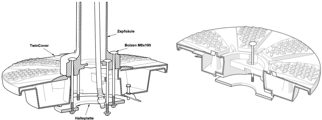
1. Der TwinCover wird mit der Zapfsäule abgebaut.
