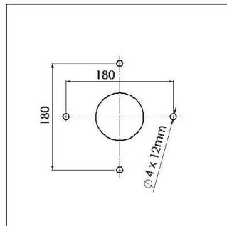
Durch ihre ebene Unterseite und die Bolzenführungen gibt es viele Möglichkeiten, die Zapfsäule anzubringen. Z.B. auf einer Gehwegplatte aus Beton, Eingießen in ein Fundament oder Verankern in Verbundstein. Hierfür gehören zum Lieferumfang 4x Dübel 12mm und 4 Tellerschrauben.
