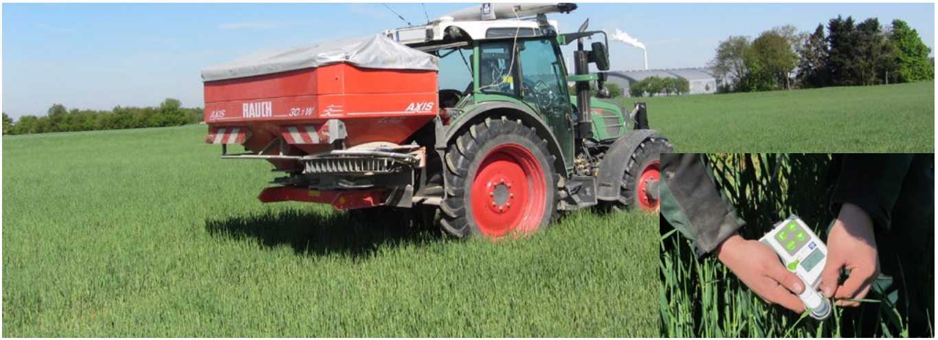
N-Sensor mit Düngemittelstreuer und N-Tester zum Kalibrieren des Sensors
