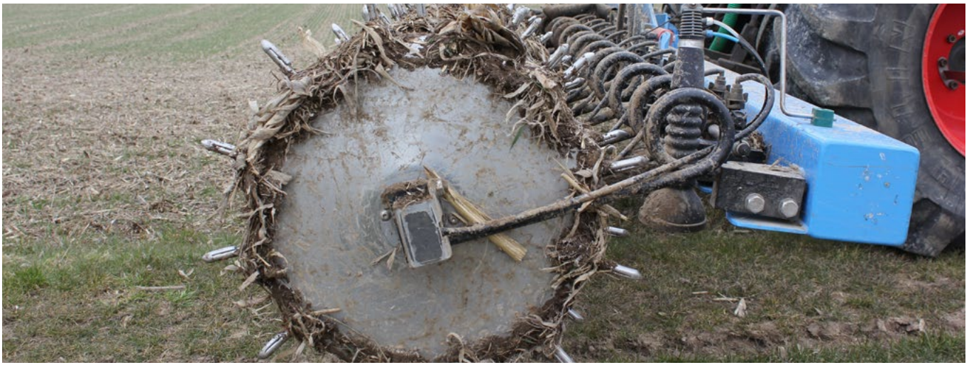
Ausbringung von flüssigem Stickstoff-Dünger mittels Sternradtechnik zu Winterweizen im Frühjahr
