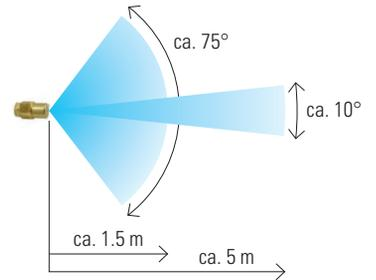
**Tipp:** Durch Entfernen des Drallkörpers aus der Standardnebeldüse kann ein Strahl bis 5 Meter erzeugt werden.
