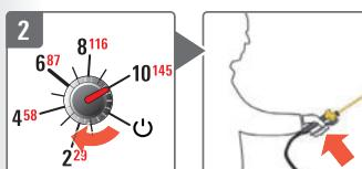
Max. Druck einstellen, sprühen bis keine Flüssigkeit mehr austritt
