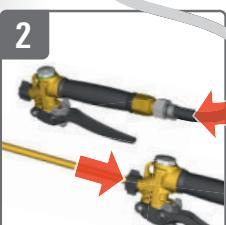
Schlauch an Handventil schrauben
