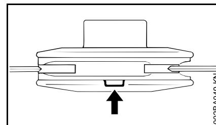
Ist am Mähkopf PolyCut eine der Markierungen nach unten durchgebrochen (Pfeil): Mähkopf nicht mehr verwenden und durch neuen ersetzen! **Verletzungsgefahr!** durch weg geschleuderte Werkzeugteile!
