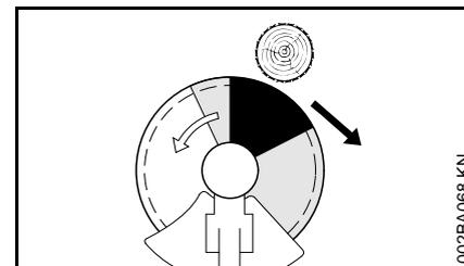
Die Rückschlaggefahr ist im schwarzen Bereich sehr stark erhöht: In diesem Bereich nie zum Schneiden ansetzen und nichts schneiden.
