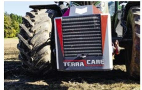
Speedfill: Die Traktorachsen können durch einen Zusatzkompressor mit externer Luft befüllt werden.
